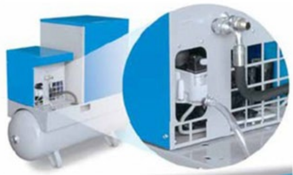
MSM maxi med tank og kjøletørker. Leveres standard med integrert ECD kondensatavleder (elektronisk nivåstyrt). Opsjon med filterkominasjon og by-pass for teknisk oliefri trvkluft. ISO 8573:1 klasse 1 – 4 – 1 (99.99% renhet).
